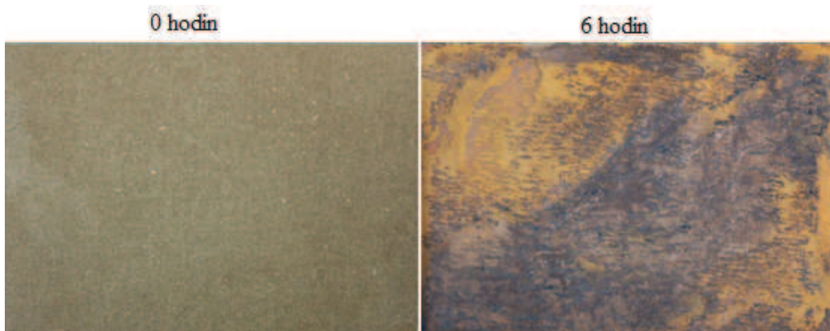
Obrázek 4: Průběh koroze na ocelovém plechu s \text{SiO}_x vrstvou 2
